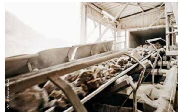
Brecherabzugsband in einem Zementwerk, Fördergurt – RIPSTOP.
