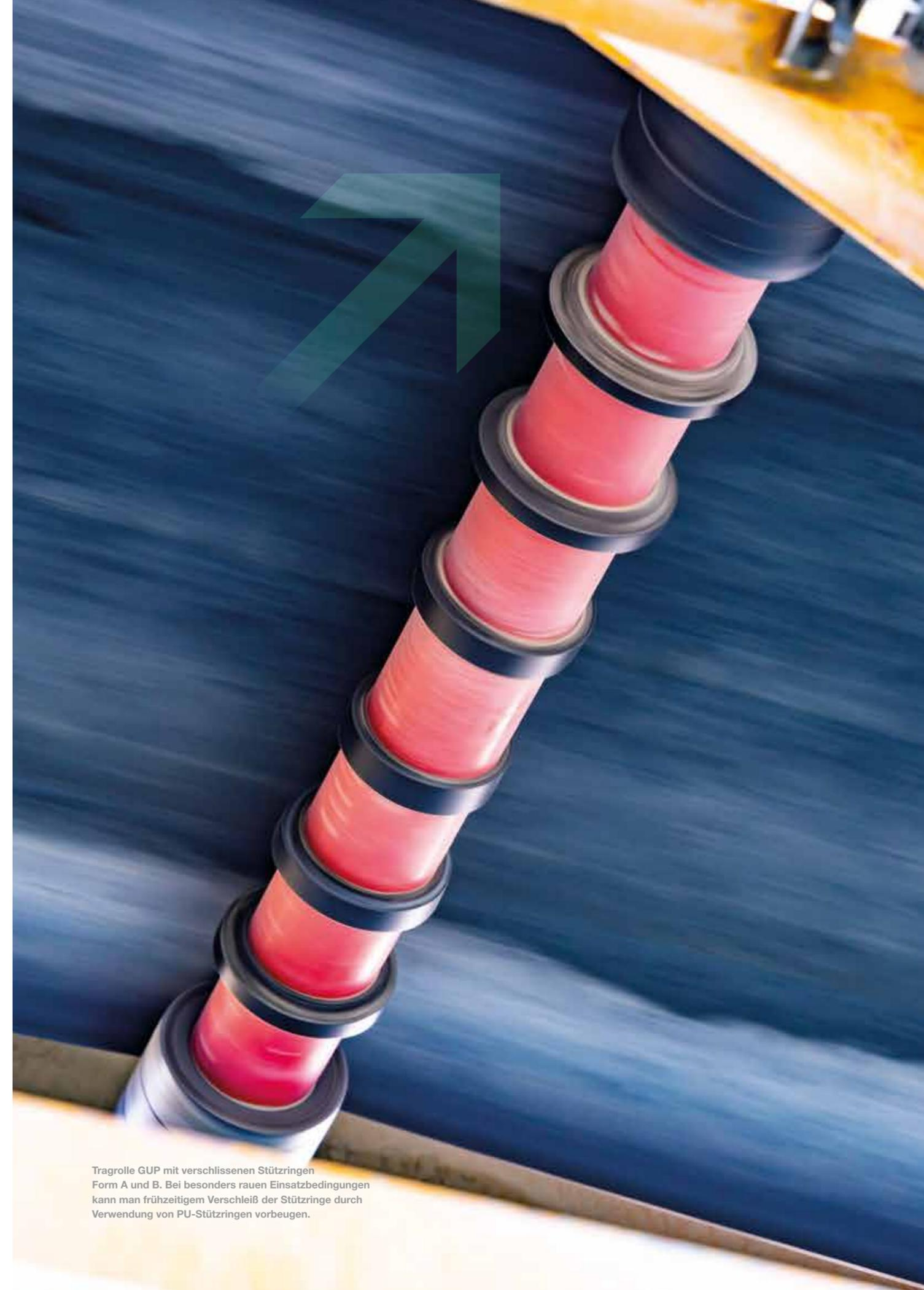
Tragrolle GUP mit verschlissenen Stützringen Form A und B. Bei besonders rauen Einsatzbedingungen kann man frühzeitigem Verschleiß der Stützringe durch Verwendung von PU-Stützringen vorbeugen.
