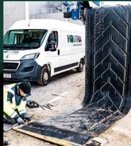
Die Stufen im Verbindungsbereich wurden mit einer Seilwinde abgezogen.
