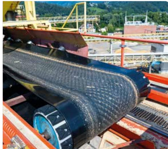
SLIDE-LAG®, montiert auf der Antriebstrommel eines Nappula-Fördergurtes.
