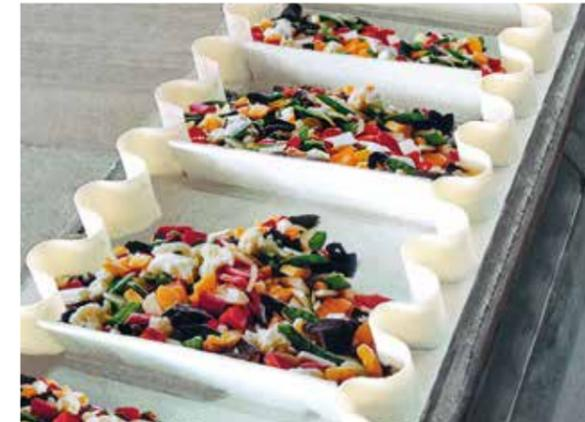
Band mit Wellkanten und Querprofilen bei der Verarbeitung von Gemüse.
