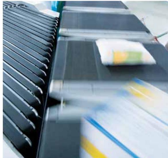
Quergurtsorter in einem Verteilzentrum. Durch Bandoberflächen mit extrem hohem Reibwert wird das Fördergut sicher beschleunigt.
