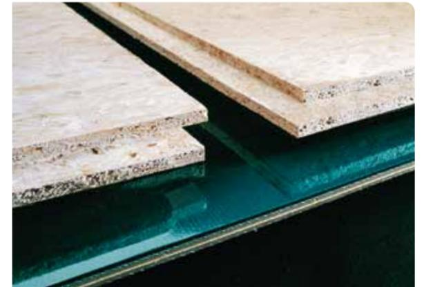
Mehrlagiger Bandtyp bei der Herstellung von Spanplatten.
