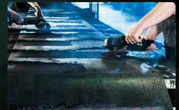
Die Deckplatte eines Fördergurtes wird händisch aufgeraut. Anschließend werden Mitnehmerprofile in vom Kunden definierten Abständen aufgeklebt.
