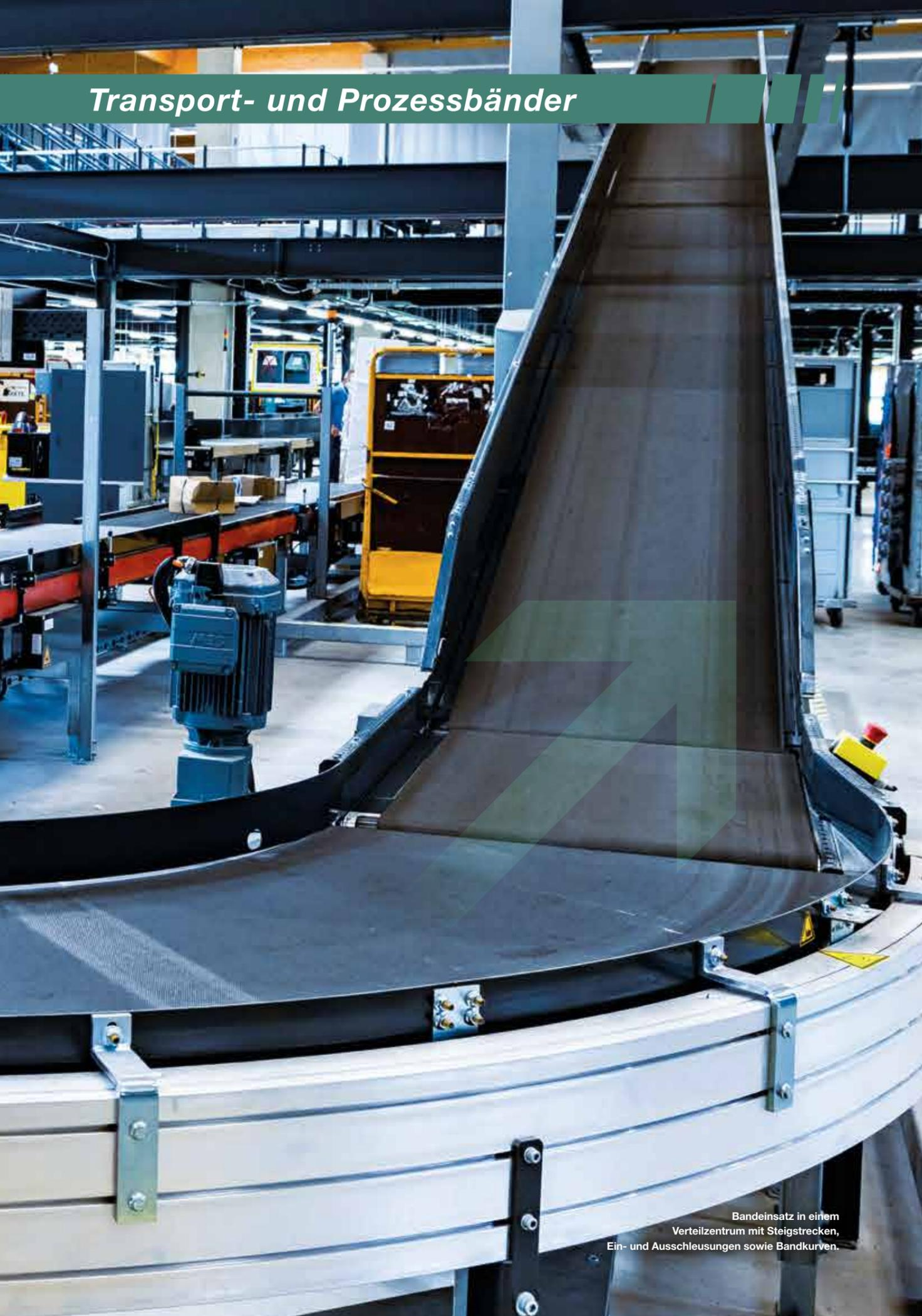
Bandeinsatz in einem Verteilzentrum mit Steigstrecken, Ein- und Ausschleusungen sowie Bandkurven.
