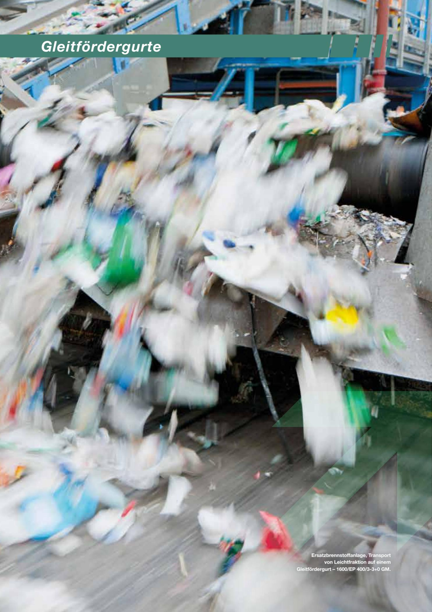
Gleitfördergurte werden überall dort verbaut, wo eine rollende Abtragung nicht möglich ist. Statt der Tragrollen verwendet man im Obertrum der Förderanlage „Gleittische“ aus Metall, Kunststoff oder Holz. Die Karkasse ist gleich aufgebaut wie bei herkömmlichen, beidseitig gummierten Fördergurten.
