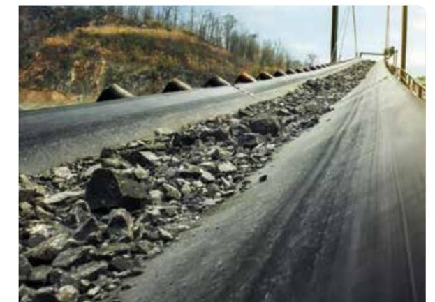
Kantkorn nach dem Backenbrecher auf einem Fördergurt – 1200/EP 630/4-8+3 X, Achsabstand ca. 170 Meter.
