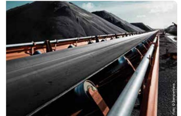
Stahlseilfördergurt zum Transport von Kohle und Eisenerz.
