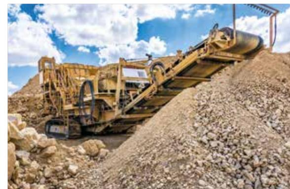
Mobile Brecheranlage in einem Steinbruch, eingesetztes Austrageband/ Fördergurt – RIPSTOP mit einer Breite von 1.000 mm.
