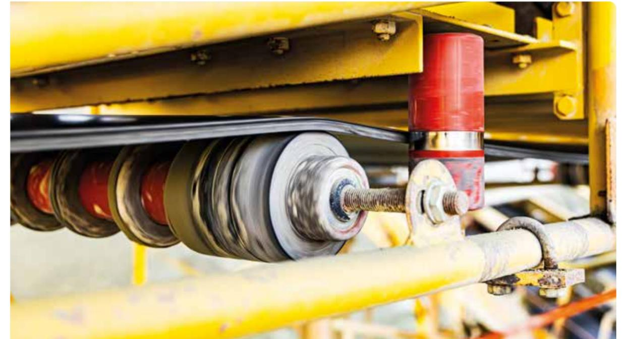
Tragrolle GST-63,5/20 – RL: 950 mm, mit Außengewinde M20 besetzt, mit Stützringen Form A und B sowie seitliche Führungsrolle GST- 63,5/20 – RL: 200 mm, mit Außengewinde M16.
