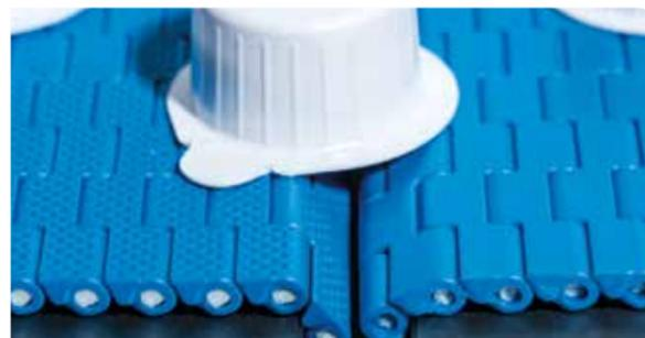
Transport von portionierter Kondensmilch. Durch sehr geringe Umlenkdurchmesser des Bandes (Prolink Serie 13) kann auch kleinteiliges Fördergut sicher übergeben werden.
