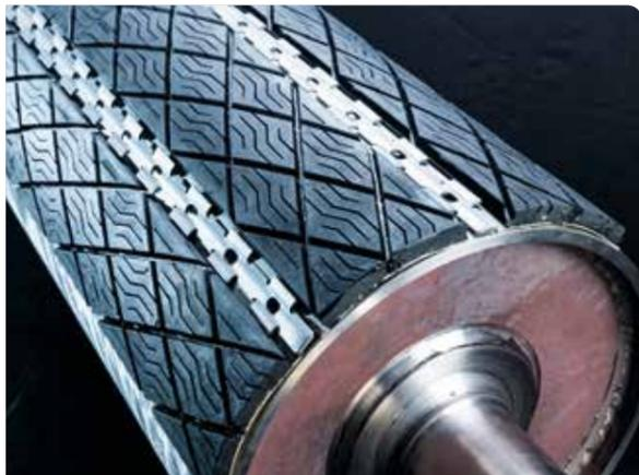
SLIDE-LAG®, montiert auf einer Antriebstrommel; Durchmesser 320 x 1.200 mm Länge.
