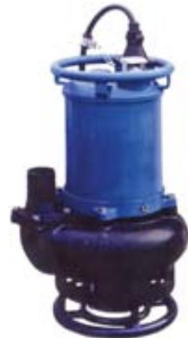
Verschleißminderung durch Laufrad aus Chromgusseisen und Saugplatte aus GG20. Spiralförmiges Gehäuse aus dickwandigem, abrasionsbeständigem Material.
