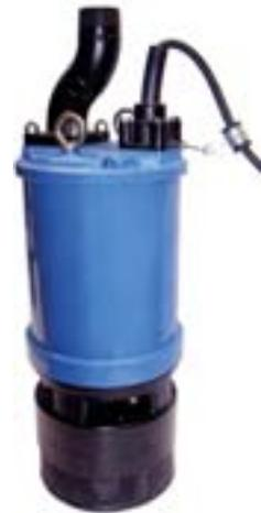
Schlanke Bauweise. Maximale Eintauchtiefe bis 50 m. Zentrierter Flansch mit Mantelkühlung, trockenlauf-sicher.
