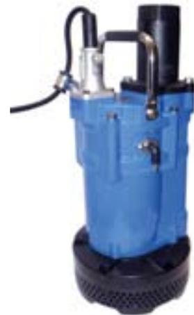
Diese Pumpen sind mit zuverlässigen und stabilen Elektroden ausgerüstet – keine beweglichen Teile! Kommt die Elektrode mit Wasser in Kontakt, startet die Pumpe. Sie stoppt nach einer Minute, sobald kein Kontakt mehr mit Wasser besteht. Individuelle Einstellung des Wasserstands.
