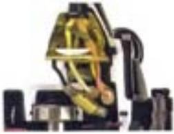
Eine kriechwassergeschützte Kabeleinführung dichtet die Pumpe gegen eindringendes Wasser ab. Da bei unseren Pumpen ein Stück jeder Phase abisoliert und die Kabeleinführung mit Kunstharz bzw. Gummi ausgegossen ist, kann garantiert kein Wasser durch die Drähte (Kapillarkräfte) zum Motor wandern. Ein Kurzschluss ist so ausgeschlossen.
