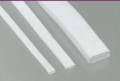
100 % reines PTFE wird völlig neuartig zu mikroporöser Faserstruktur verändert. Es erreicht dadurch eine hervorragende Kombination mechanischer Eigenschaften. Flexoflon ist weich, geschmeidig und flexibel; beste Abdichtung im Mikrobereich, da sich die Flachdichtung durch Anpressdruck in ein dünnes, breites Band verwandelt, das alle Unebenheiten und Ritzen ausfüllt. Anwendung an Pumpen und Getriebedeckeln, als statische Abdichtung an ebenen und gekämmerten Flanschverbindungen
