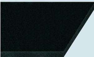
Spezial EPDM Qualität mit geschlossener Zellstruktur, ohne Haut, gut alterungs- und witterungsbeständig, weiche, elastische, zusammendrückbare Qualität
