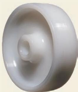
Rad aus Polyamid 6, leichter Lauf unter schwerer Last, hygienisch, korrosionsbeständig und schlagfest, Nabe mit wartungsfreiem Gleitlager
