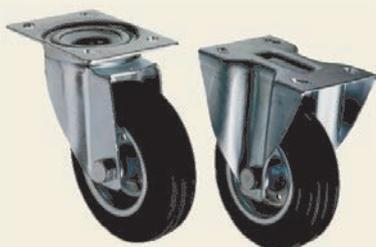
**Mittellastausführung:** Rad aus schwarzem Vollgummi, Felge aus chromverzinktem Stahlblech, Rollenlager, Befestigungsplatte Lenkrollen mit und ohne Feststeller lieferbar!
