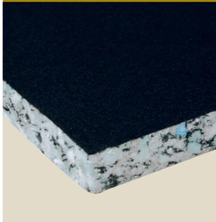
Verbundschäum RG 90, Brandklasse nach FMVSS 302 (DIN 75200) SE/NBR, selbstverlöschend Akustikvlies (S 288-001) schwarz, schwer brennbar
