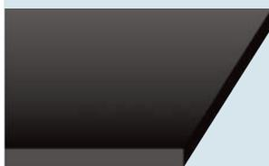
NBR Qualität, gut öl- und benzinbeständig bis 30 % Aromatengehalt, gute mechanische Eigenschaften
