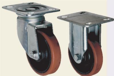
Serie ZETA P 60: Radkörper aus Gusseisen mit Polyurethan-Bandage, Gehäuse aus chromverzinktem Stahlblech, Präzisions-Rillenkugellager, große Abrieb- und Reißfestigkeit
