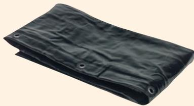
Type TRANS-TAC T 75 M aus dunkelgrüner, durchscheinender Kunststoff-Folie, beidseitig mit stabilen Kunststoff-Druckknöpfen zur Aneinanderreihung mehrerer Vorhänge, oben verstärkte Ringösen mit Ø 12 mm; die Vorhänge sind funkenfest und flammwidrig, für Lichtbogenschweißverfahren nach EN 1598, Gefährdungsfaktor: ca. 0,05;
