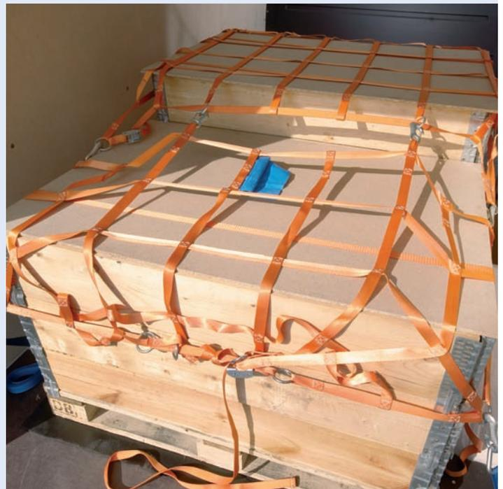
Wenn die Ladung einmal sperriger ist oder aus vielen Elementen besteht, können Sie das Basisnetz mit dem Erweiterungsnetz vergrößern. Es wird einfach mit den Ösen des Basisnetzes verbunden und vergrößert. Die Sicherungsfläche um rund 50 %.
