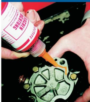
Geeignet als Flächendichtung für verwindungssteife Metallflansche aus Stahl und Stahlguss wie z. B. Gussgehäuse, Pumpen etc.
