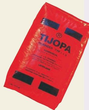
Spezifisch geschliffene Gummimehle, zur universellen Bindung von Ölleckagen und bestimmten Chemikalien, Tijopa ist schwimmfähig und folglich nicht wasserbelastend, 1 Sack bindet ca. 80 Liter Heizöl.
