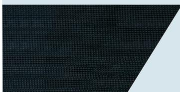
Hochelastische Naturkautschukqualität, gute Witterungs- und Alterungsbeständigkeit, abriebfest, Oberfläche Stoffimpression. Einsatzbeispiele: Abdichtung zwischen beweglichen und starren Maschinenteilen, z. B. Aufgabetrichter und Siebmaschine
