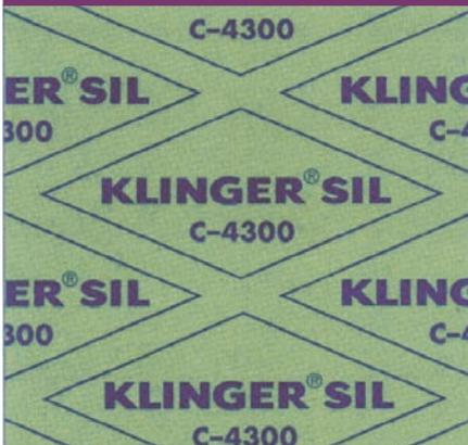
Universell einsetzbare Hochdruckdichtung mit breitem Anwendungsspektrum und guter Druckstandfestigkeit; beständig gegen Heißwasser, Dampf, Öle und Kohlenwasserstoffe. Einsatzgrenzen siehe Druck/Temperaturdiagramm
