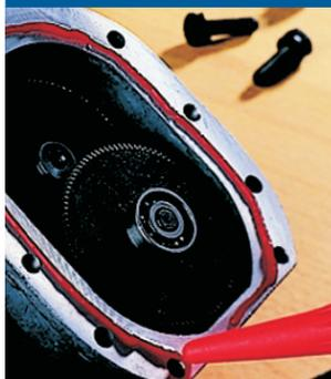
Flächendichtung für Aluminiumteile, bei denen eine gewisse Elastizität gefordert wird, für Alu-Getriebe, Motorgehäuse etc.
