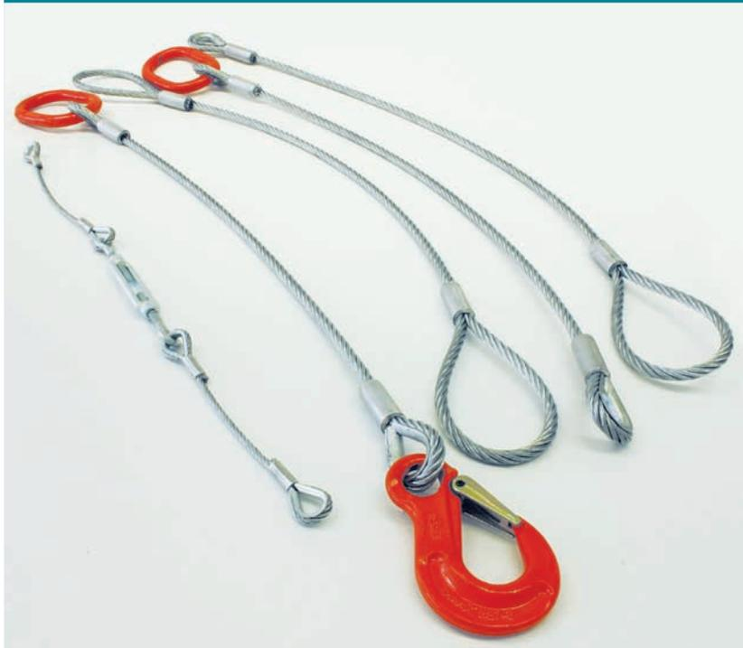
Die Anschlagseile werden aus verzinkten Stahldrahtseilen mit Talurit-Pressklemmen hergestellt. Nennfestigkeit 1.770 N/mm<sup>2</sup>.
