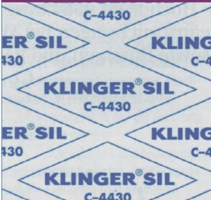
Universell einsetzbare Hochdruckdichtung mit höchster Druckstandfestigkeit und hoher Beständigkeit gegen Heißwasser und Dampf; auch ausgezeichnet beständig gegen Öle und Kohlenwasserstoffe. Einsatzgrenzen siehe Druck/Temperaturdiagramm
