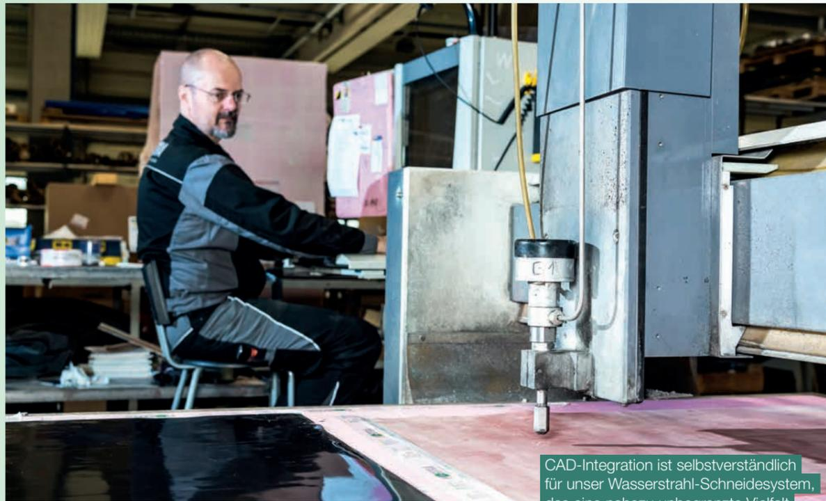
CAD-Integration ist selbstverständlich für unser Wasserstrahl-Schneidesystem, das eine nahezu unbegrenzte Vielfalt an Formen (auch sehr komplexen) und Materialien erlaubt – bis hin zur Kleinserie von Bauteilen.
